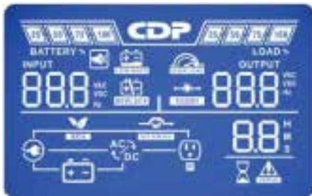
Muestra voltajes de entrada, salida, tiempos de autonomía de batería
